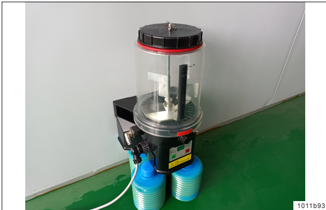
Fig. 37 - Påfyllning av pumpens behållare
